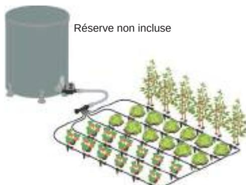
Si la réserve est placée au même niveau que le système d'irrigation, elle peut être installée jusqu'à 10 mètres de l'entrée du peigne de répartition.
