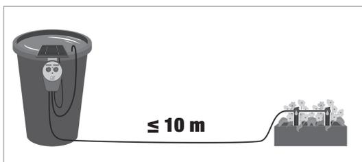
Distance maximale entre la source d'eau et le point d'arrosage : **≤ 10 mètres**
