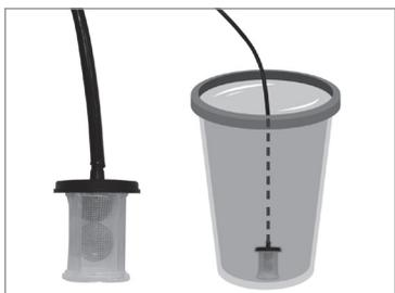
3. Brancher l'autre extrémité du tuyau à la crépine et positionné la au fond de votre réserve d'eau pour un bon fonctionnement.
