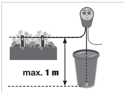
Le dénivelé entre les goutteurs et la crépine peut être de **1 mètre maximum**.
