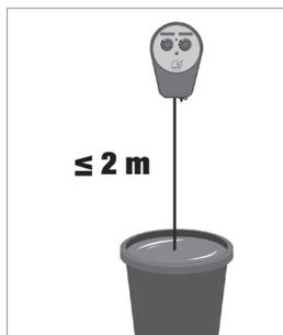
Hauteur max. du DripPump par rapport à la réserve d'eau : **≤ 2 mètres**
